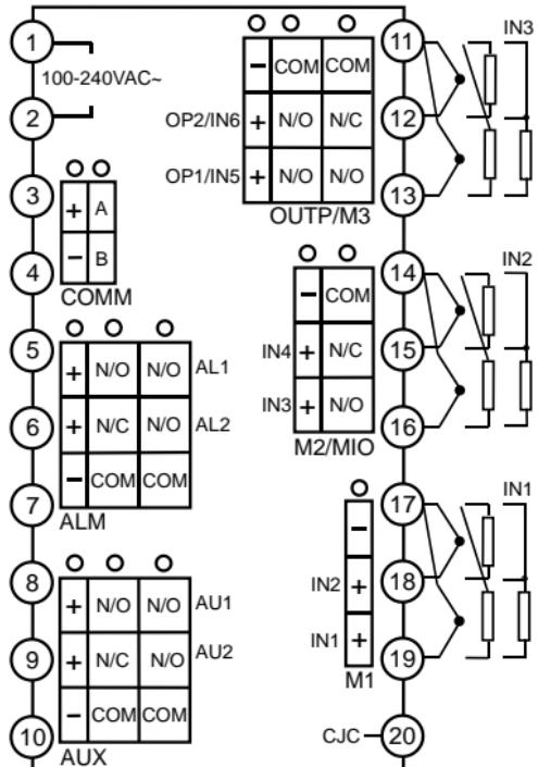
注：本图为 A、C、E 型竖式面板的式仪表接线图。
