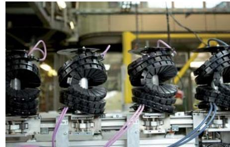
易格斯拖链和电缆的扭转和扭曲测试。
