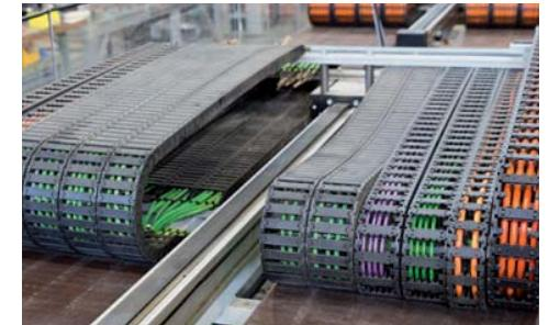
易格斯电缆和轴承的使用寿命测试。
