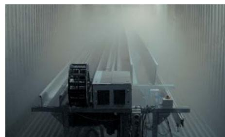
拖链和高柔性电缆在-40°C的低温下的测试。
