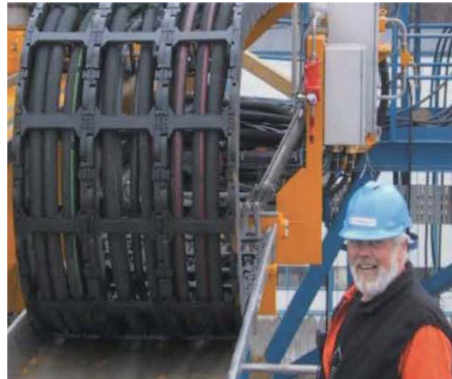
igus® 拖链重载案例：行程1.2m，拖链负载 50kg/m...
