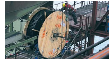
易格斯专家在起重机上安装装配拖链系统。拖链和电缆的总重量达 2 吨。
