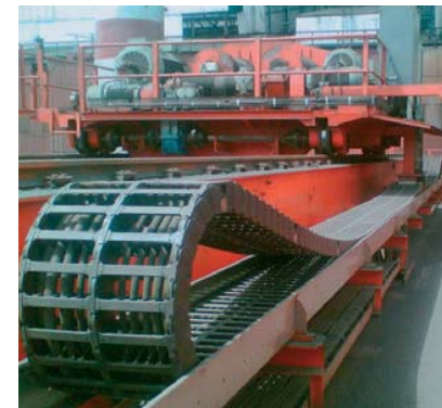
易格斯轮式拖链 5050R 系列用于印度钢厂内，在充满腐蚀性气体的工况中运行着： S = 22 \text{ m} ， a = 1 \text{ m/s}^2
