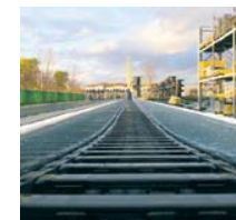
长程测试: 行程 125 m, 速度 300 m/min
