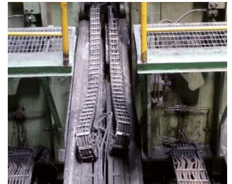
金属拖链遭受冲击后导致永久变形
