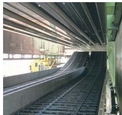
装配好的拖链系统用于卸船机中，行程 106 米，速度 4 m/s，负载 25 kg/m
