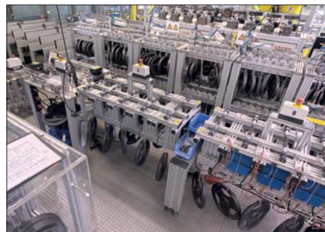
在轴承实验室里进行磨损测试，易格斯克隆总部。
