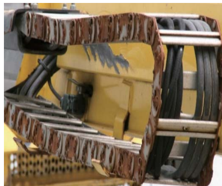
标准的镀锌钢拖链抗腐蚀能力较差...
